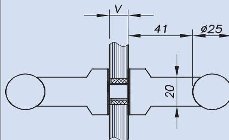
Glasbohrung Modell C mit Verbindungsstift Ø 12 mm und Glas-Schutzring Ø 18 mm
