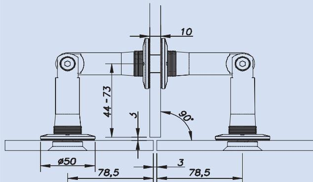
Les renvois d'angle sont livrés montés avec les vis pour le verre. Si des composants sont perdus ou endommagés, ils peuvent être remplacés à la demande. (Voir détail pages suivantes).
