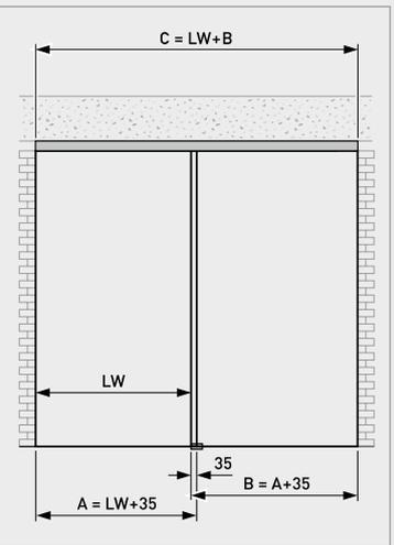
**Deckenmontage 1flg.,** in Einzelgarnituren bis 975 mm bzw. 1475 mm Flügelbreite, alternativ Lagerlängen oder Fixmaß
