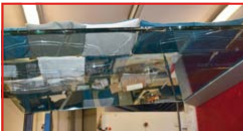
ÉTAPE 4 Résistance post-rupture
