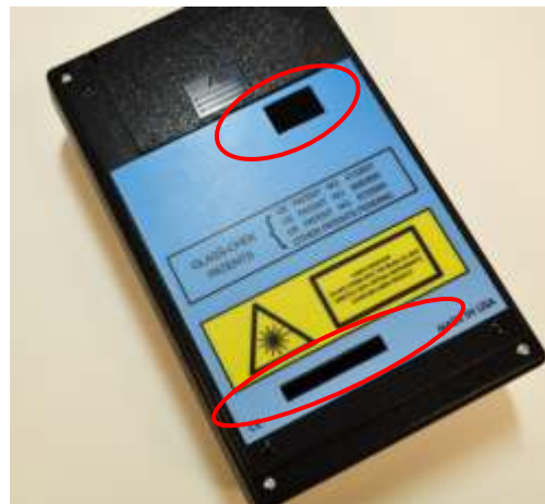
Abb. oben: Rückseite eines GC3200-Messgeräts mit zwei runden Linsen. Verwenden Sie saubere Druckluft, um die Linsen zu reinigen.
