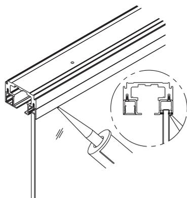
Vitrage réalisé par le client avec du silicone.
