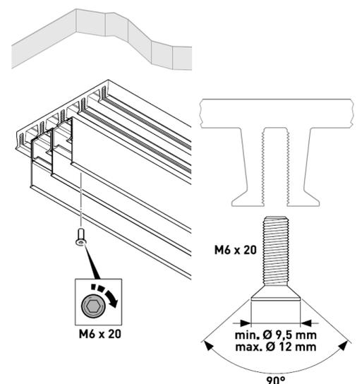
Das Deckenverbindungsprofil selbst muss gemäß Montageanleitung Portavant 150 multiline nur noch alle 500 mm mit zwei Schrauben an der Decke bzw. der Deckenkonstruktion befestigt werden. Das Deckenverbindungsprofil kann zum Nivellieren entsprechend unterlegt werden.
