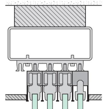
Bitte beachten Sie, dass die Ganzglasschiebetüranlage dynamische Kräfte in Längs- aber auch in Querrichtung auf das Deckenverbindungsprofil übertragen kann. Das Deckenverbindungsprofil oder der zusätzliche Rohrträger müssen entsprechend gegen Bewegungen in alle Richtungen befestigt werden. Die gesamte Tragkonstruktion muss von einem Statiker geprüft und vor Montage freigegeben werden.
