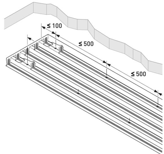
In Anhangdecken bietet es sich an, beispielsweise einen weiteren Rechteckrohrträger aus Stahl von der Decke nivelliert abzuhängen und das Deckenverbindungsprofil daran zu befestigen. Für eine schnelle Montage des Deckenverbindungsprofils an dem Rechteckrohr können beispielsweise Schnellbohrschrauben in das Rechteckrohr getrieben werden. Das Deckenverbindungsprofil muss dafür zuvor zum Schraubendurchmesser passend vorgebohrt werden und ist dafür mit Anbohrillen versehen.
