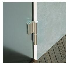
**○** Charnière hydraulique Biloba EVO / EVO Frame avec ferme-porte intégré, fermeture automatique à partir de 85°
