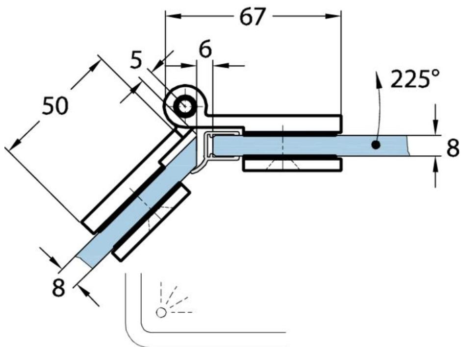
Mit Dichtprofil // with use of seal
