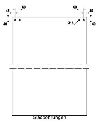
2. Schiebeflügel (mit schwebender Bodenführung)
