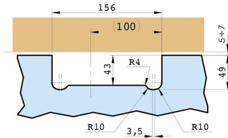
Glasbearbeitung für schwenkende Installation
