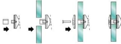
SADEV préconise de monter les écrous au frein filet, sauf contrainte spécifique de montage.
