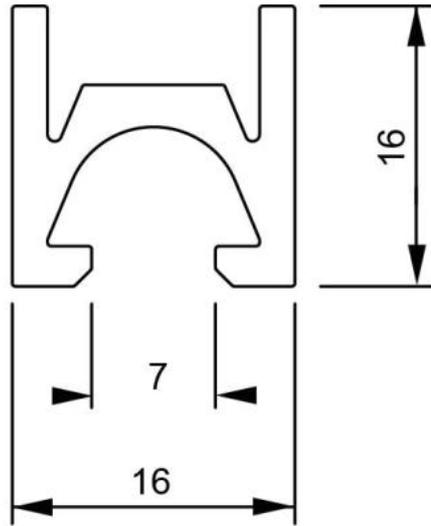
Abstand der Anschraublöcher 100 mm /  $\varnothing$  3,5 mm
