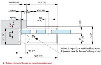
Distancia minima de hilo pared, para facilitar la rotación del vidrio Minimum distance from wall edge in order to facilitate glass rotation Mindestdistanz von der Wandkante, um die Glasrotation zu erleichtern Distance minimum de l'arrête du mur pour permettre la rotation du verre
