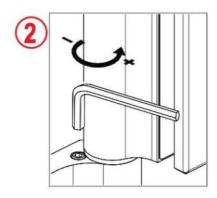
Regolazione della velocità di chiusura Ajuste de la velocidad de cierre Closing speed adjustement Regulierung der Schließgeschwindigkeit Réglage de la vitesse de fermeture
