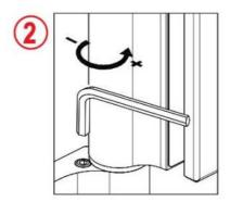
Regolazione della velocità di chiusura Ajuste de la velocidad de cierre Closing speed adjustement Regulierung der Schließgeschwindigkeit Réglage de la vitesse de fermeture
