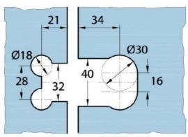
Mit Dichtprofil / avec joint
