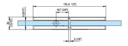
automatische Öffnung, bzw. Schliessung ab 15°
