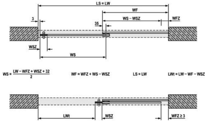
Eintragung der Profillänge von Laufschiene und Blende (mm)
