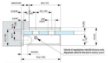
Distanza minima da filo muro per consentire rotazione vetro Distancia minima de hilo pared, para facilitar la rotación del vidrio Minimum distance from wall edge in order to facilitate glass rotation Mindestdistanz von der Wandkante, um die Glasrotation zu erleichtem Distance minimum de l'arrête du mur pour permettre la rotation du verre
