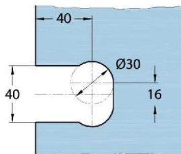
Mit Dichtprofil / avec joints
