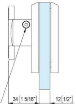
Einstellung Schliessgeschwindigkeit Réglage de la vitesse de fermeture Valvola di regolazione velocità chiusura anta Adjustment valve for the door's closing speed
