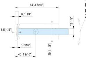
0°-Punkt-Regulierung Réglage du point 0 Regolazione del punto 0 Zero point adjustability
