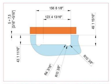
Lavorazione vetro per applicazione pivottante - Glass processing for pivoting applications
