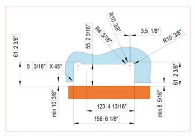
Lavorazione vetro per applicazione pivottante - Glass processing for pivoting applications
