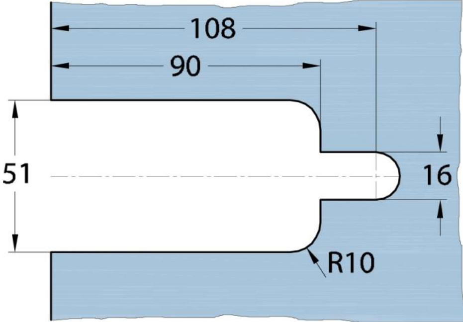
Mit Dichtprofil // with use of seal
