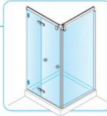
La présente notice décrit la pose d'un dispositif avec l'ouvrant placé du côté droit. Procéder à un montage en symétrie pour un ouvrant gauche.
